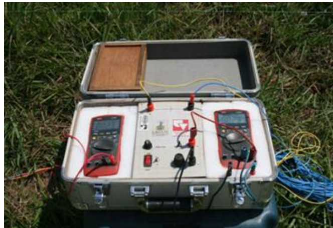
Figura 4. Modelo de Georresistivímetro utilizado durante la cuarta temporada de campo en la sede Meléndez de la Universidad del Valle.
