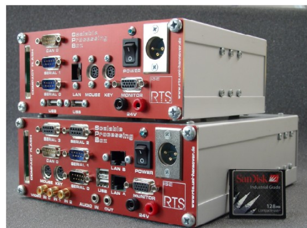
Fig. 8. Dos cajas de procesamiento escalable (SPB) con distintas capacidades periféricas, desarrolladas en el RTS.
