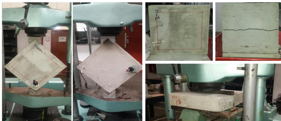
Figura 4. Ensayo de muretes a la compresión diagonal y a la flexión a 28 días de curado
