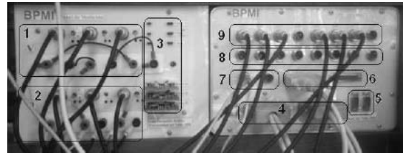
Figura 3. Tablero Interfase de señales del BPMI: 1)Entrada sensores de voltaje, 2)Entrada sensores de voltaje, 3)Filtros análogos, 4)Puerto comunicación con dSPACE, 5)Conectores RS485 y RS232, 6)Salidas de usuario, 7)Entradas encoders, 8)Salidas conversores D/A, 9)Entradas conversores A/D.
