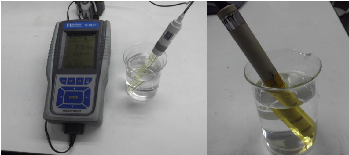
Figura 6. Montaje para la medida de conductividad y pH de los geles obtenidos.
