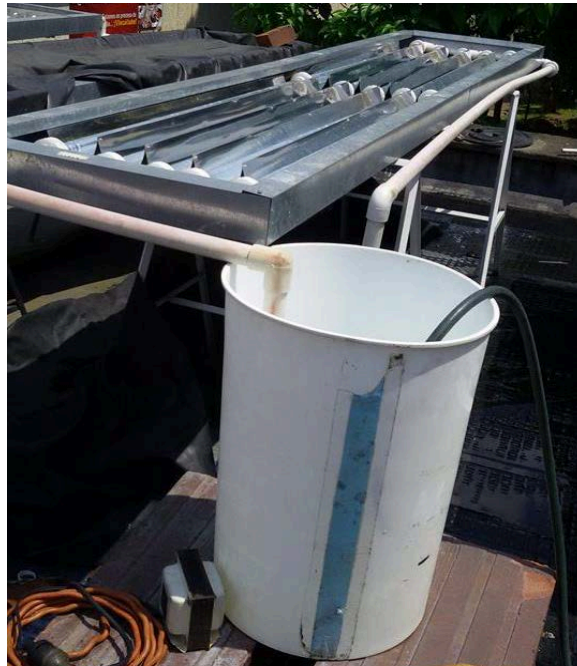
Figura 6. Reactor CPC expuesto a irradiación solar.
