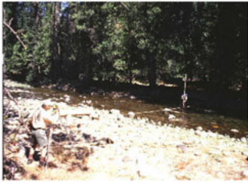
Figura 3. Levantamiento hidrotopográfico de una sección transversal representativa de un hábitat tipo "tabla". Los múltiples puntos de estacionamiento definen las celdas en las que se conceptúa dividida la sección para realizar la modelación hidráulica.
