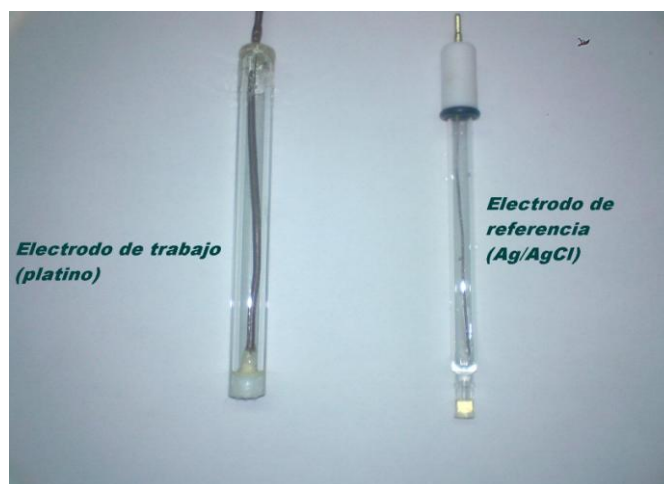
Figura 4. Fotografías de los electrodos (trabajo y referencia) utilizados en las mediciones electroquímicas.
