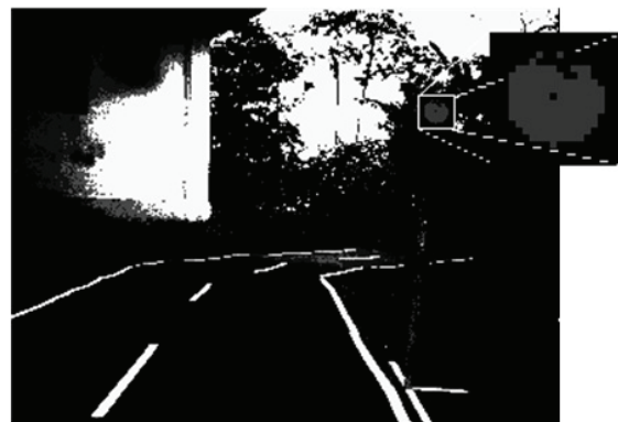
Figura 6. Zona de acotamiento para extraer características de la señal de semáforo.
