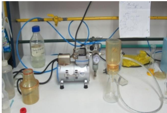
Figura 6. Sistema de Bomba de Vacío y Equipo de filtración.
