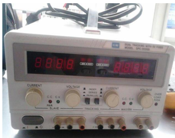
Ilustración 56. Fuente regulada GW INSTEK GPC-3030D
