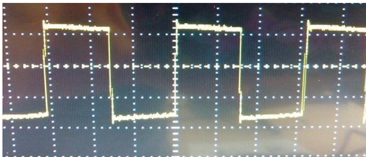
Ilustración 60. Señal de entrada al integrado LM324 tipo cuadrada, 3.2kHz, 1 V/División; V_{pp} 3.31 V; V_{min} 0V; V_{max} 3.31 V
