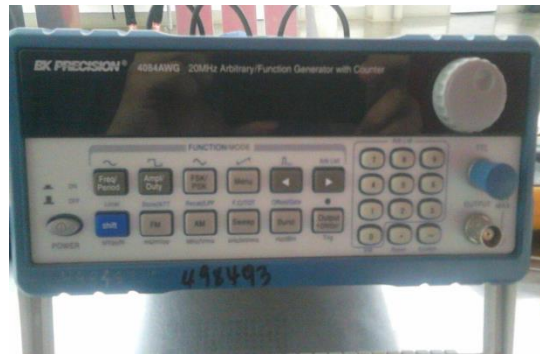
Ilustración 58. Generador de señales BX PRECISION 4084 AWG
