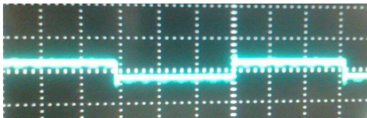
Ilustración 78. Señal medida al ser transmitida a 32.5 m, Vmax 1.38 V, Vmin -0.96 V, Vpp 2.35 V, Frecuencia 3.205 kHz, 5 V/División
