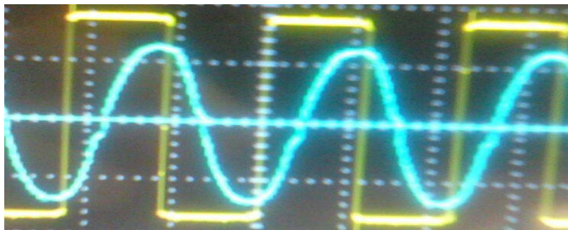
Ilustración 70. Señal de entrada al filtro pasa banda 8.865 kHz (Amarilla), Vpp 7.03 V, Vmin -3.44 V, Vmax 3.59 V, 2 V/División; Señal del salido del filtro pasa banda 8.865 kHz (Azul), Vpp 5.36 V, Vmin -2.72 V, Vmax 2.64 V, 2 V/División; Atenuación 23.75 %
