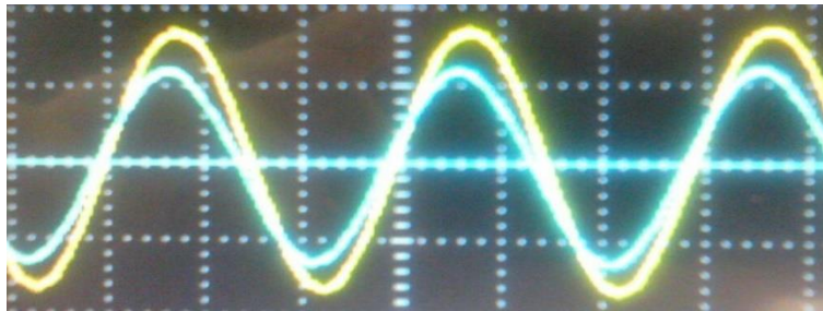
Ilustración 67. Señal de entrada al filtro pasa banda 3.413 kHz (Amarilla), V_{pp} 5.76 V, V_{min} -2.79 V, V_{max} 2.96 V, 2 V/División; Señal del salida del filtro pasa banda 3.425 kHz (Azul), V_{pp} 4.48 V, V_{min} -2.16 V, V_{max} 2.31 V, 2 V/División; Atenuación 22.2 %
