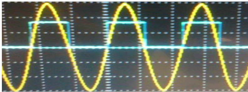
Ilustración 65. Señal de entrada al integrado LM311 8.757 kHz (Amarilla), V_{pp} 11.9 V, V_{min} -6.05 V, V_{max} 5.92 V, 2 V/División; Señal de salida del integrado LM311 8.757 kHz (Azul), V_{pp} 3.44 V, V_{min} 0 V, V_{max} 3.44 V, 2 V/División
