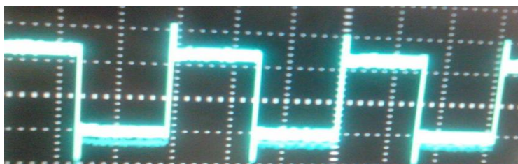
Ilustración 77. Señal medida al ser transmitida a 32.5 m, Vmax 1.38 V, Vmin -0.96 V, Vpp 2.35 V, Frecuencia 3.205 kHz, 5 V/División
