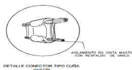
Ilustración 38. Conector tipo cuña (WACP) tomado de planos anexos NMA3-01 EPSA tomado de [27]
