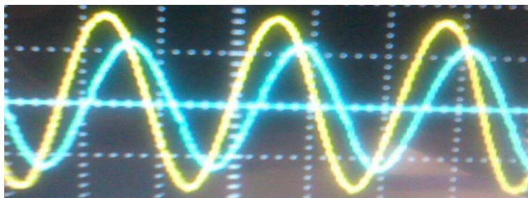
Ilustración 68. Señal de entrada al filtro pasa banda 8.898 kHz (Amarilla), V_{pp} 6.63 V, V_{min} -3.27 V, V_{max} 3.35 V, 2 V/División; Señal del salida del filtro pasa banda 8.865 kHz (Azul), V_{pp} 5.03 V, V_{min} -2.55 V, V_{max} 2.45 V, 2 V/División; Atenuación 24.13%
