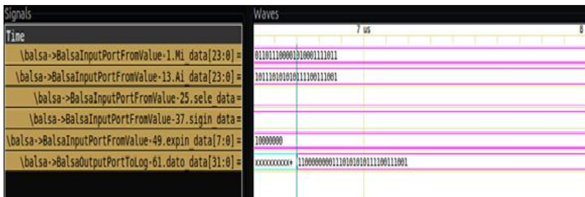
Figura 2.25. Simulación temporal del circuito asíncrono Balsa _suma.
