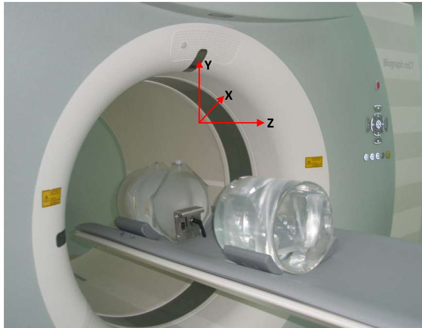
Figura 4.12. Alineamiento de los maniqués en el Gantry del tomógrafo.
