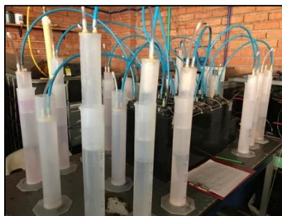
Figura 12. Configuración volumétrica con trampa de NaOH al 3% con medición de CH 4 en probeta
