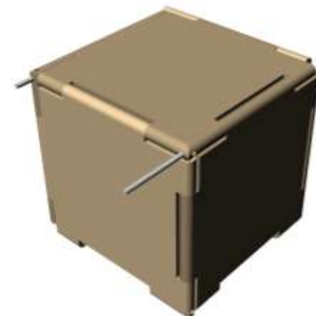
Grafico 22: unión superior con varillas
