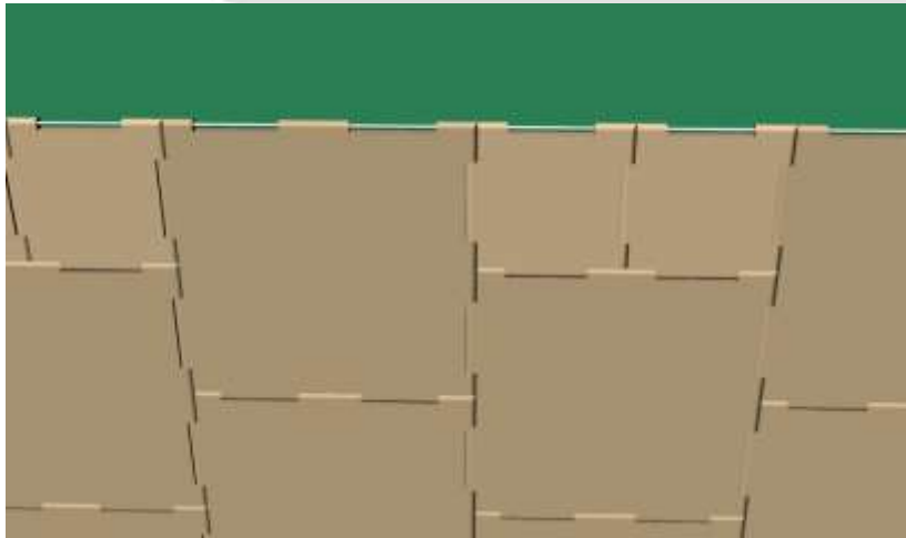
Grafico 48: varillas pasando a través de los módulos.
