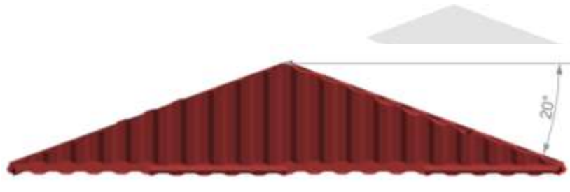
Grafico 34: vista lateral de 4 módulos formando el techo mínimo
