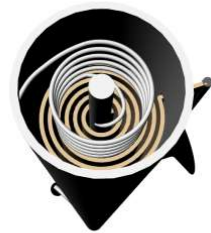
Grafico 41: Vista superior del tubo con la lona enrollada y el resorte en su estado inicial.
