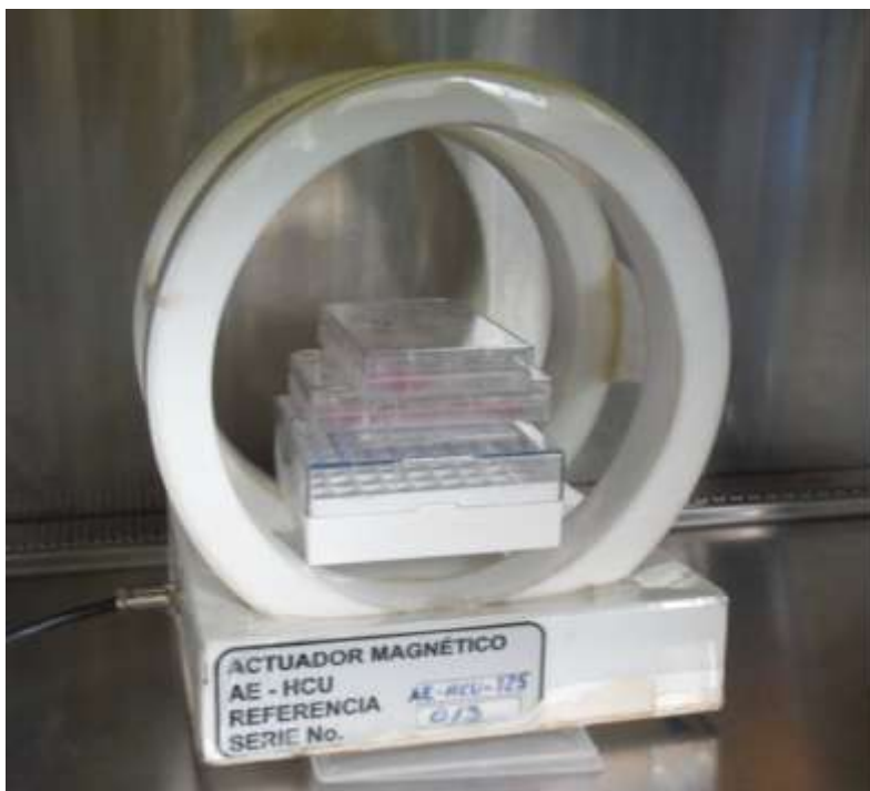
Figura 5. Montaje de las placas dentro del magnetoreactor.
