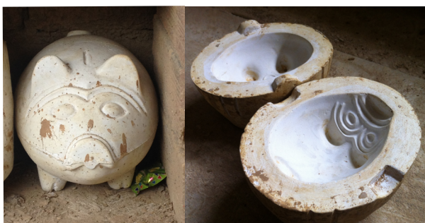
Figura 9: Matriz o modelo en yeso usado para la elaboración del molde
