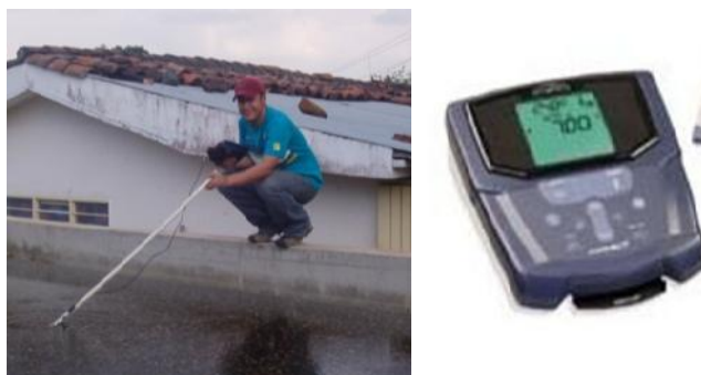
Figura 8 Medición de la conductividad en el filtro
