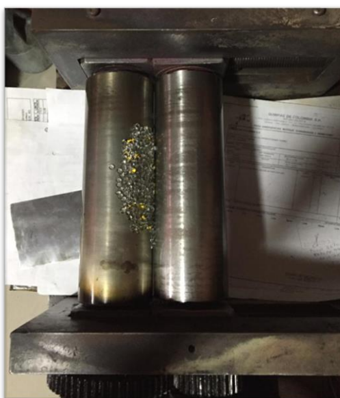
Figura 31. Materia para ser fundido en maquina bicilindrica. Fuente: elaboración propia.
