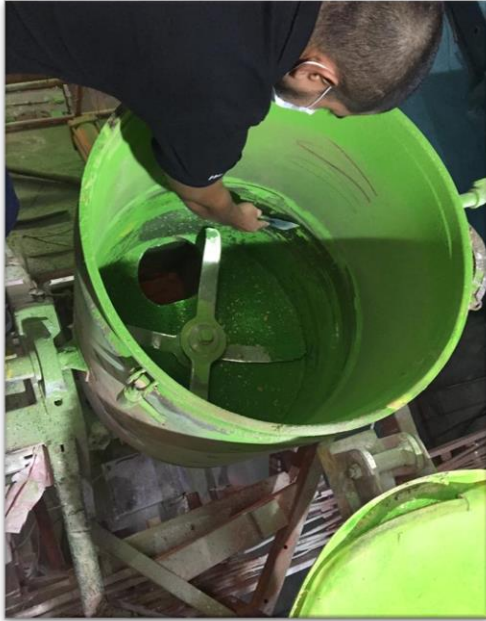
Figura 8. Limpieza del mezclador. Fuente: elaboración propia.
