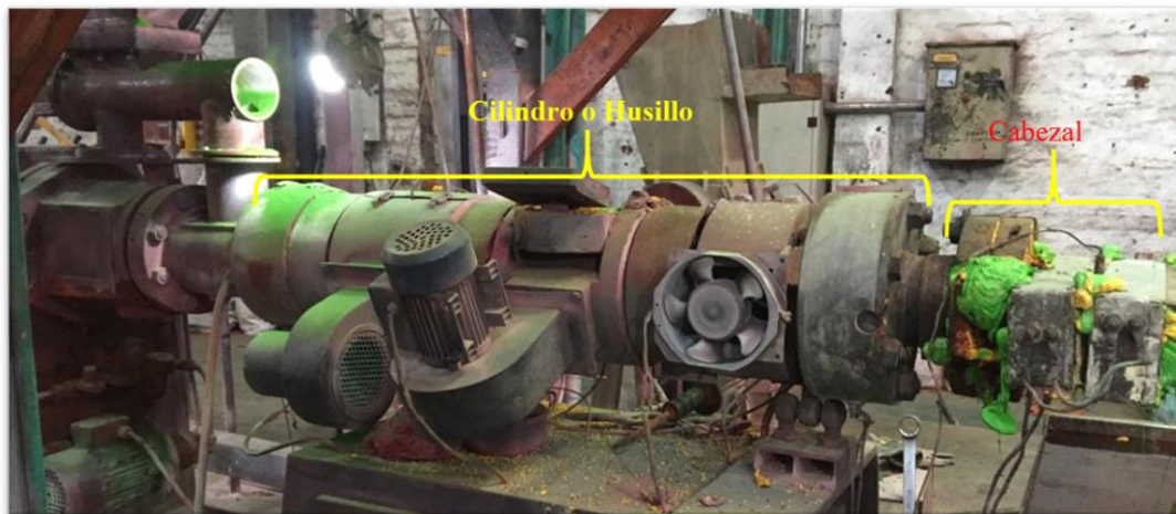
Figura 20. Cilindro con tornillo en su interior por donde se funde el material, seguido de cabezal de distribución del material. Fuente: elaboración propia.
