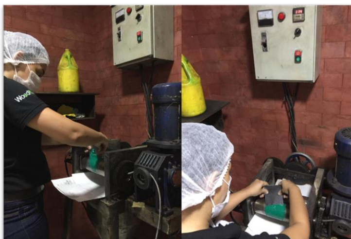
Figura 32. Mezcla de muestra con los cilindros giratorios y ayuda de espátula. Fuente: elaboración propia.
