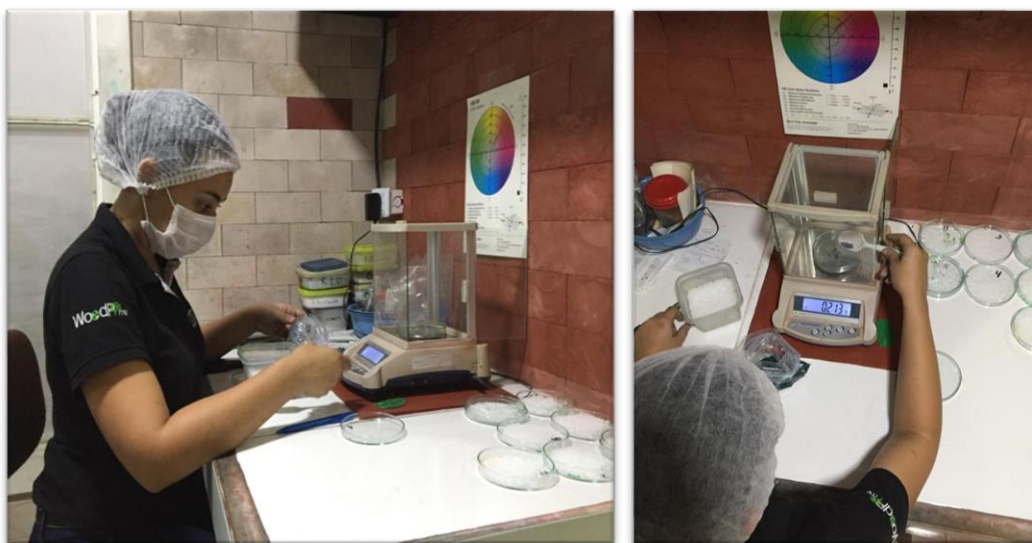
Figura 29. Proceso de pesaje del material con polietileno de baja densidad para realizar las tres pruebas. Fuente: elaboración propia.
