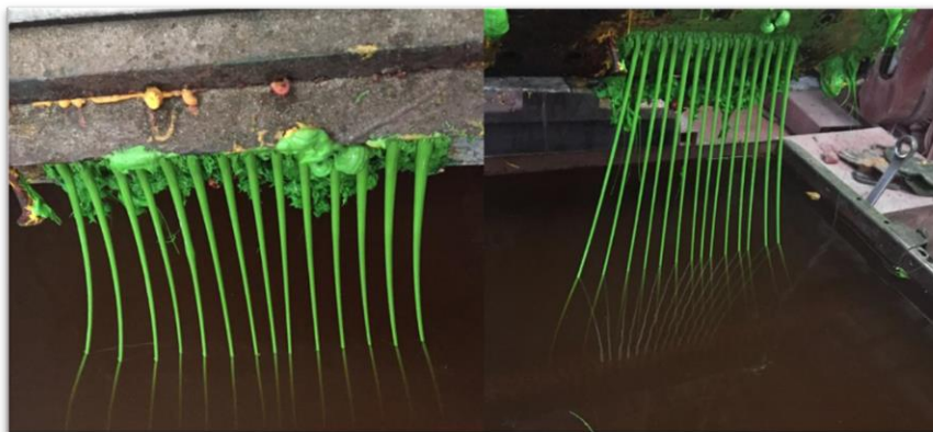
Figura 21. Expulsión distribuida de material por el cabezal. Fuente: elaboración propia.
