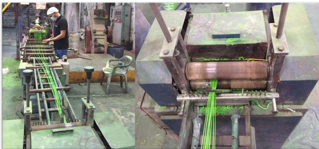
Figura 23. Traslado de material por halado de rodillos de la peletizadora. Fuente: elaboración propia.
