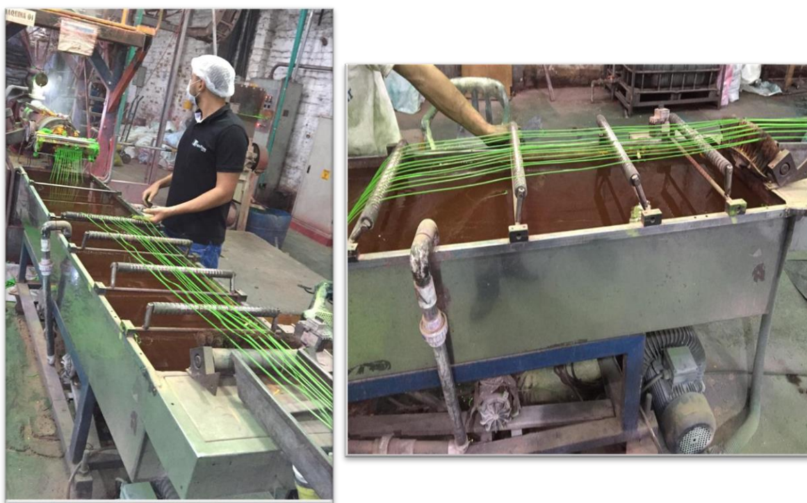
Figura 22. Proceso de enfriado del material en la tina con supervisión del operario. Fuente: elaboración propia.
