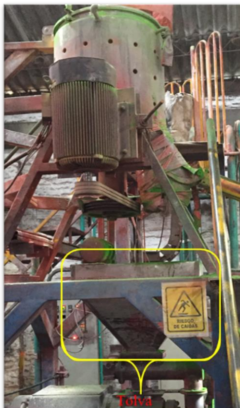
Figura 16. Tolva de descargue de material mezclado. Fuente: elaboración propia.
