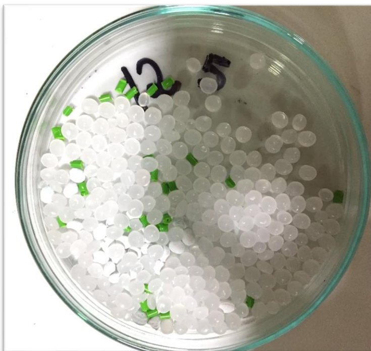
Figura 30. Producto terminado de masterbatch con polietileno de baja densidad para evaluación. Fuente: elaboración propia.
