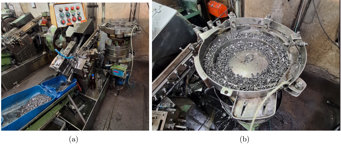
Figura 5.4: Máquina de roscado y funcionamiento del aire comprimido en la máquina
