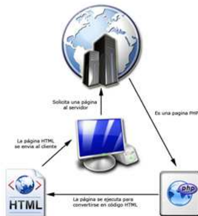
Figura 2.2: Esquema del funcionamiento de PHP
