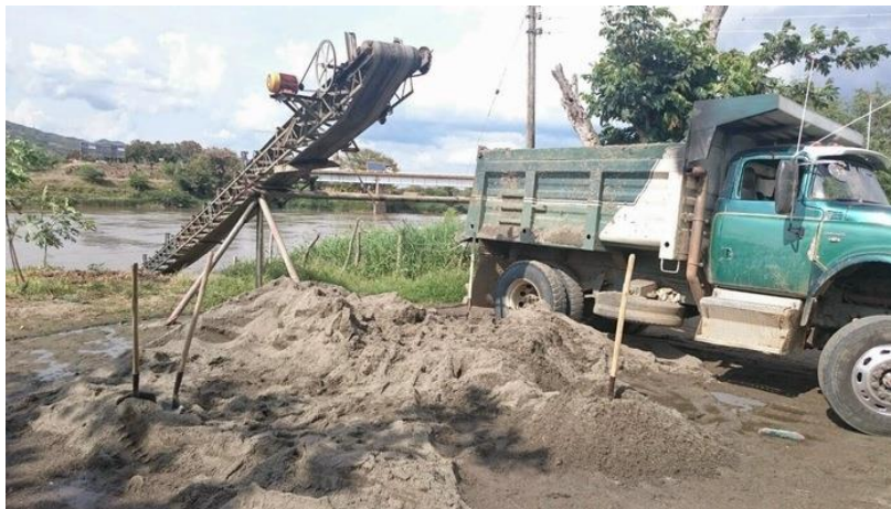
Ilustración 39. Infraestructura artesanal para la extracción de arena. Fuente: Registro Fotográfico propio.
