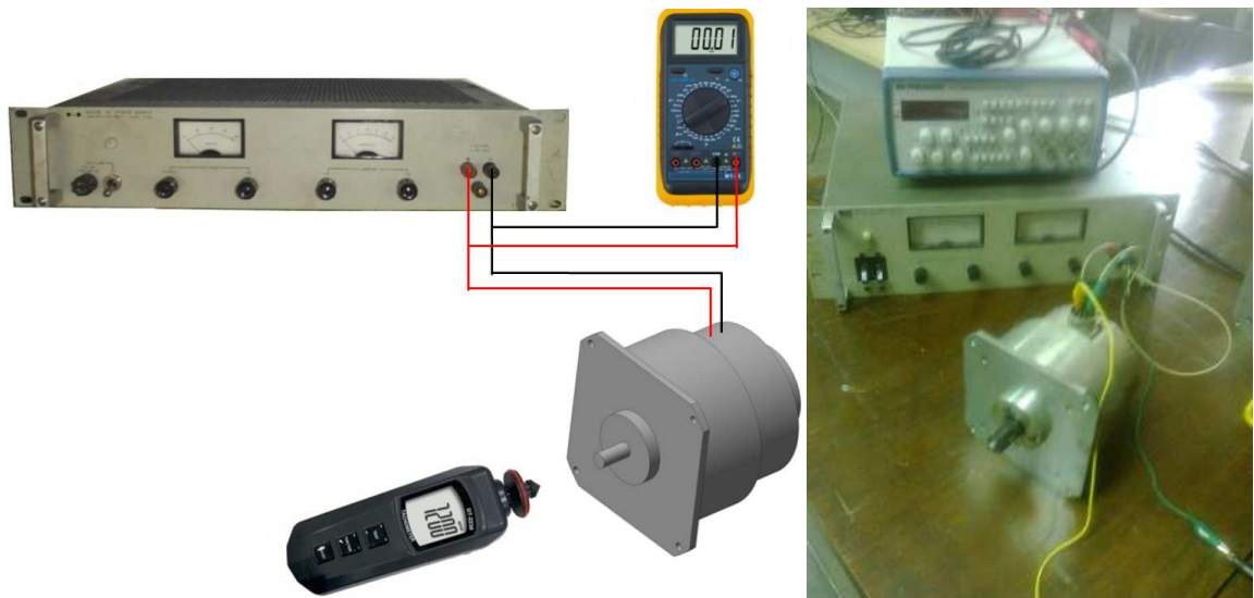
Figura 10. Esquema de prueba para encontrar el comportamiento cinemático del motor sin carga bajo a diferentes niveles de potencial.
