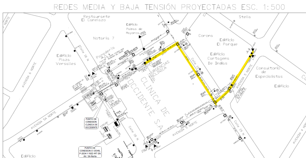
Figura 50. Propuesta segundo circuito alimentador Clínica de Occidente
