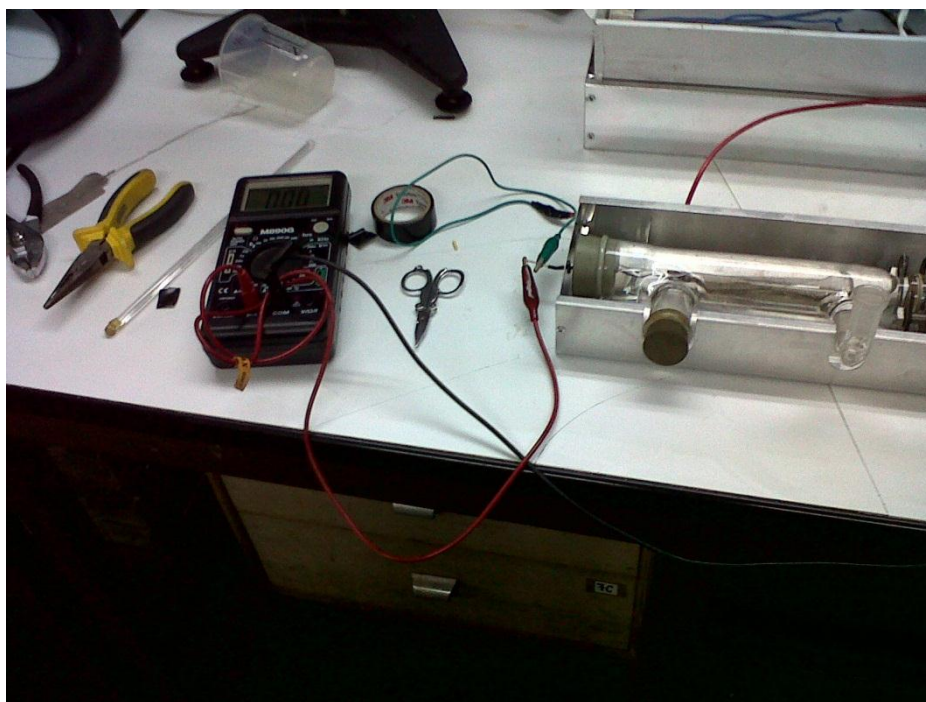
Figura 10. Sistema de medición de diferencia de potencial
