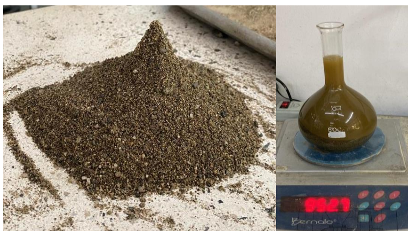
Figura 7. a) Condición saturada y superficialmente seca, y b) masa del picnómetro con agua.
