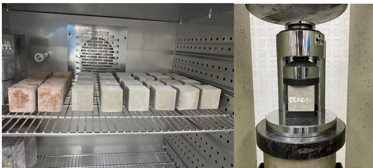
Figura 16. (a) Cubos en la cámara, (b) Ensayo de Resistencia a la compresión ambiente carbonatado.
