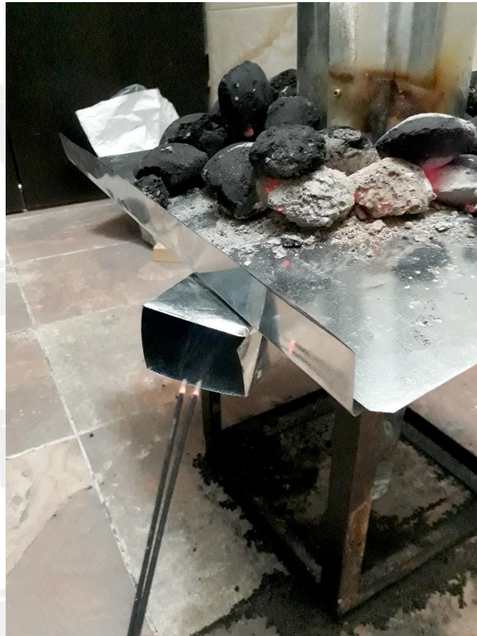
Figura 66. Comprobación, Corriente de aire ascendente dentro de la chimenea. Velas de Incienso.
