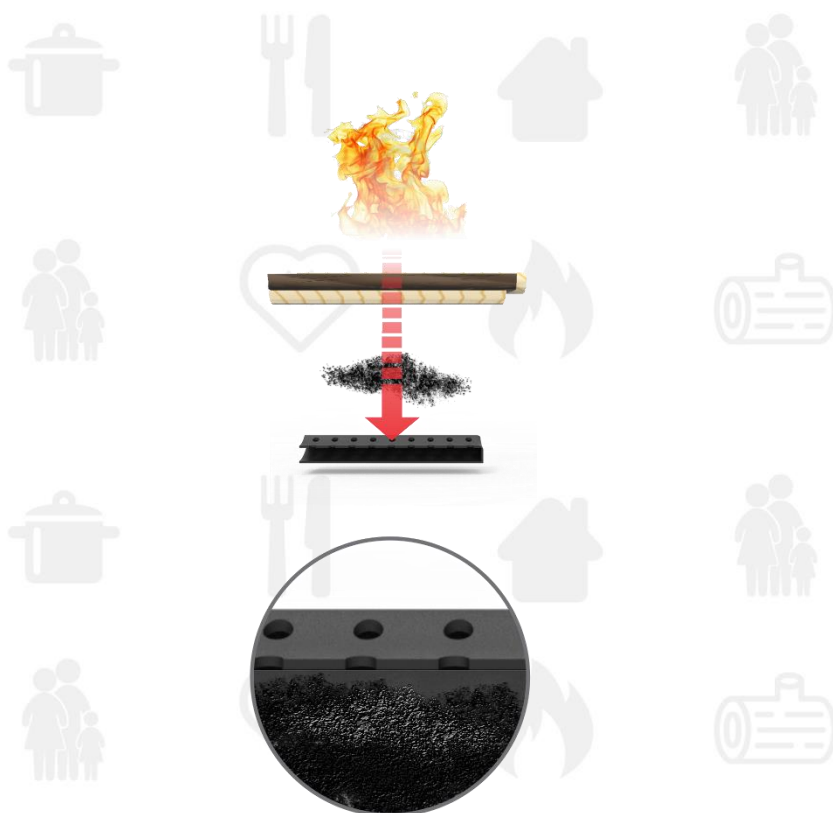
Figura 56. Acumulación de Cenizas, Cenicero, Cámara de Combustión.
