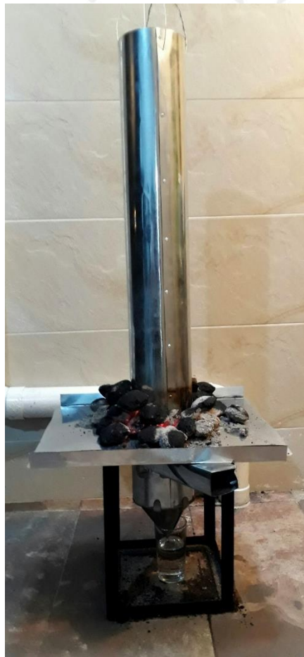
Figura 64. Experimento, Chimenea, Lámina Galvanizada.
