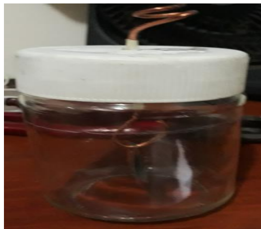
Figura (36): Electroscopio y su respectiva construcción.
