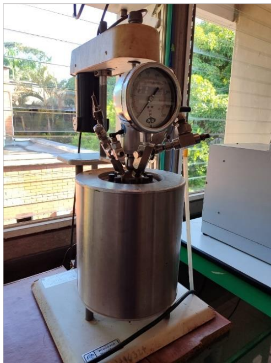
Figura 8. Reactor Parr para la carbonización hidrotérmica
