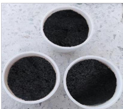
Figura 13. Hidrocarbonizado H-300-5 obtenido en la HTC
