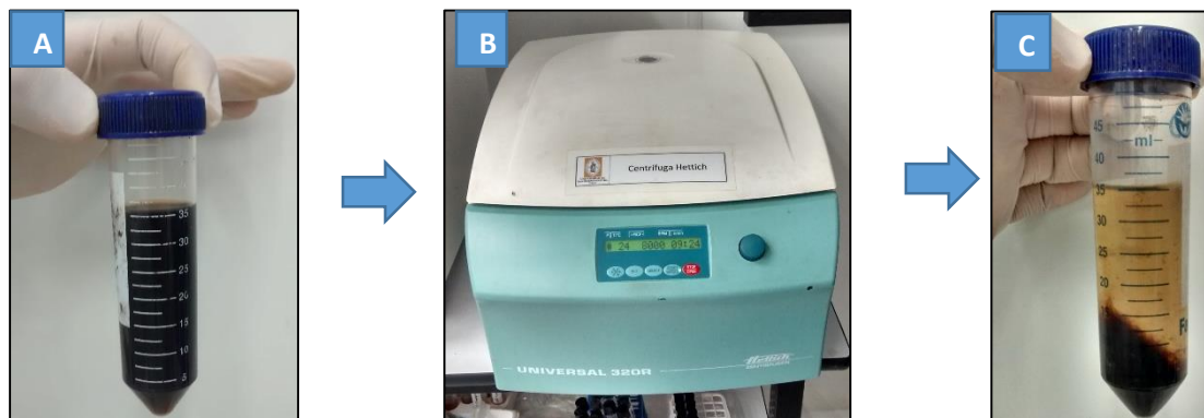
Figura 10. Proceso de centrifugado. A) Solución sin lavar, B) Centrifugado, C) Separación de sedimento – residuo.
