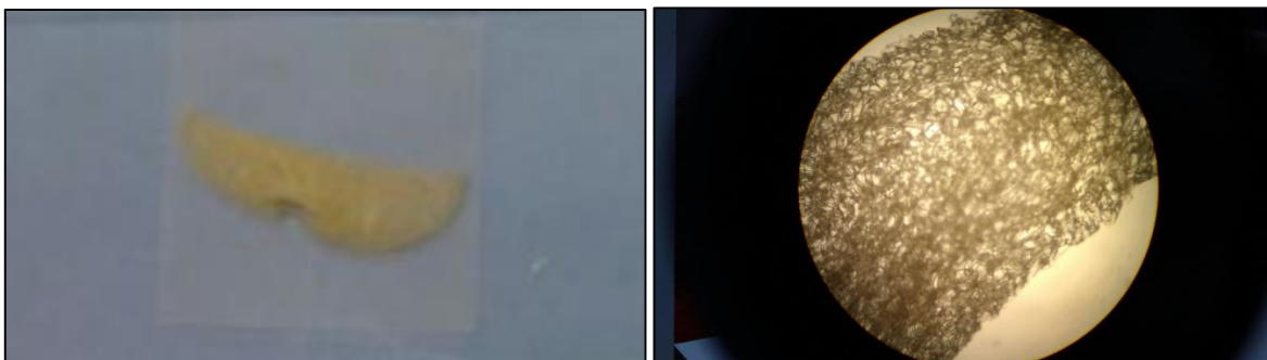
Figura 24. Andamio cortado y observado mediante un microscopio óptico.
