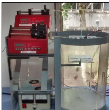
Figura 17. Montaje de electrohilado para la elaboración de andamios de QS-GO.
