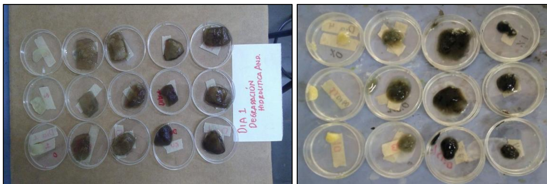
Figura 20. Extracción y secado de la probeta inmersa en FBS para el posterior registro de sus pesos. Día 1 de ensayo (izquierda), Día 21 de ensayo (derecha).
