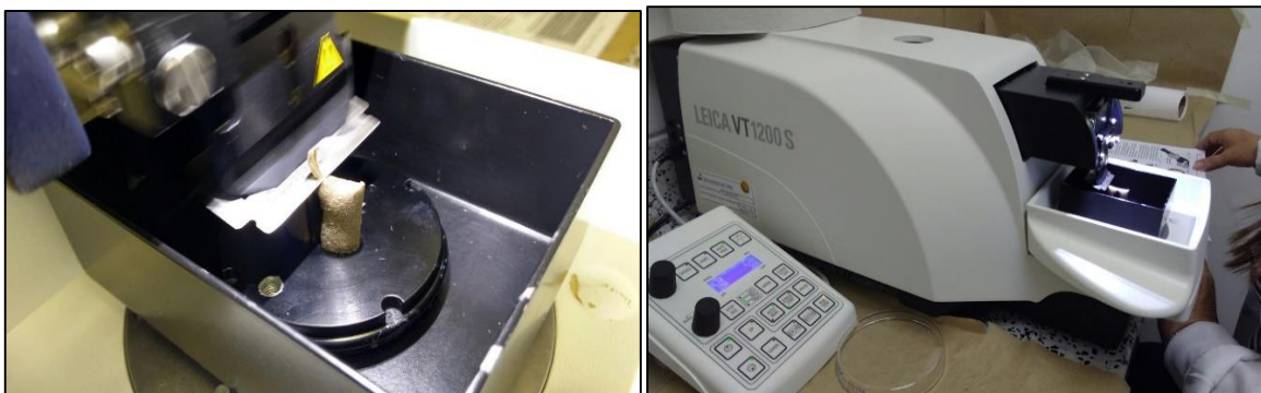
Figura 23. Equipo y proceso de corte de los andamios.
