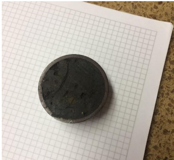
Ilustración 23. Anillo con muestra después de prueba de consolidación unidimensional.
