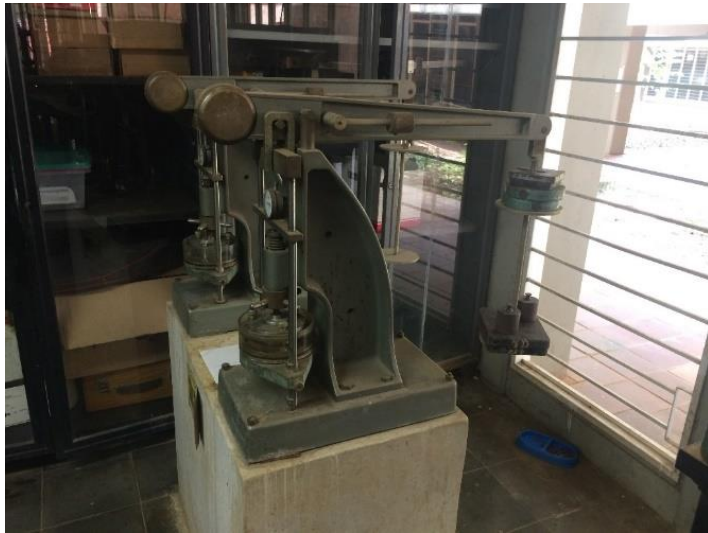
Ilustración 22. Consolidómetros durante pruebas de expansión (Izq) y consolidación (Der).
