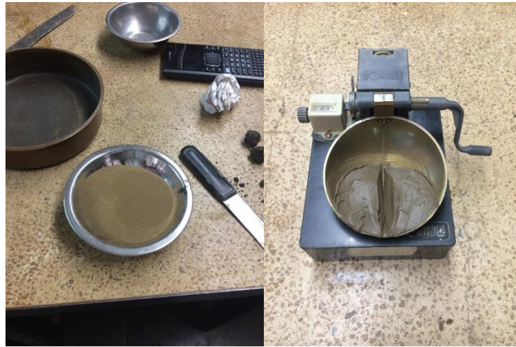
Ilustración 19. Muestra de suelo pasada por el tamiz No.40 (Izq). Muestra de suelo después del ensayo para Límite Líquido (Der).
