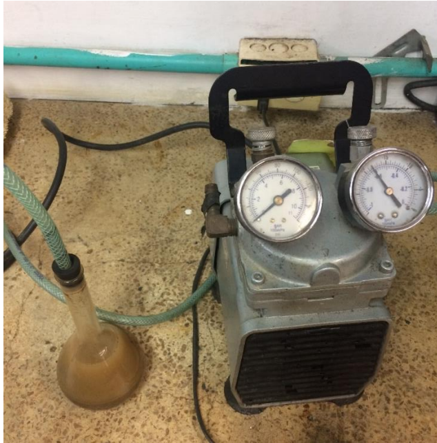
Ilustración 18. Picnómetro durante ensayo para determinar la gravedad específica en la fase de extracción de aire de la muestra en la bomba de vacío.
