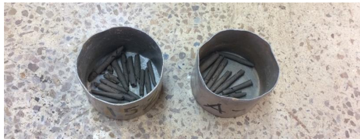
Ilustración 20. Muestra del suelo después del ensayo de Límite Plástico.
