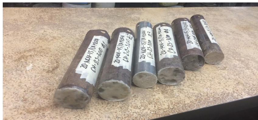
Ilustración 17. Muestras inalteradas con prevención de pérdida de humedad.
