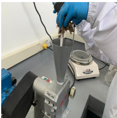
(b) Ingreso de la muestra al molino
