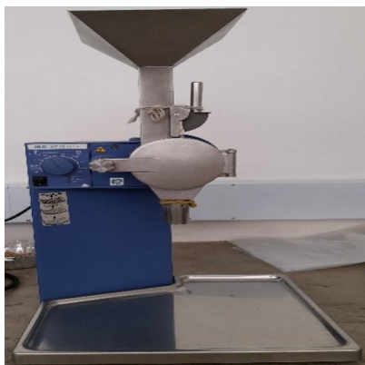
(a) Molino para triturar la muestra
