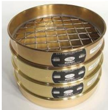
Figura 4. Ejemplo de un sistema de tamices.
