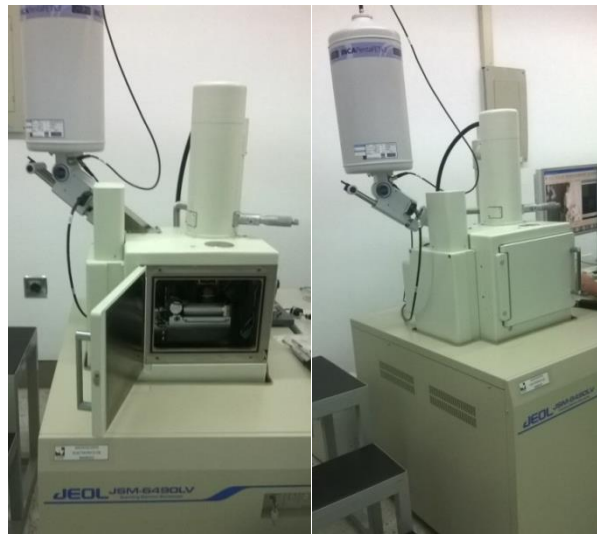
Figura 12. Microscopio Electrónico de Barrido y la cámara de vacío con portamuestras
