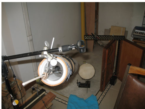
Figura 2.1: En el experimento el micrófono apunta hacia una pandereta sujeta con un prensa.
