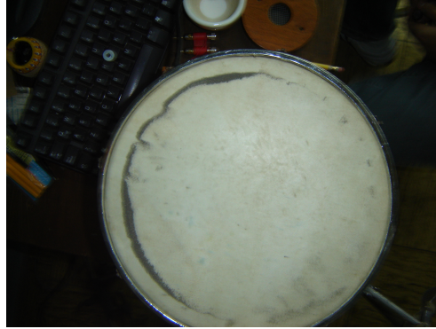
Figura 2.12: Posición final de la arena tras excitar la membrana de la pandereta con un parlante vibrando a una frecuencia de 60 Hz.
