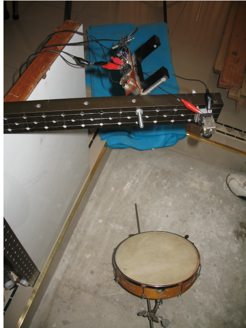
Figura 2.2: Sobre la pandereta se encuentra un electroimán que deja caer balines sobre la misma parte de la pandereta y con la misma intensidad.
