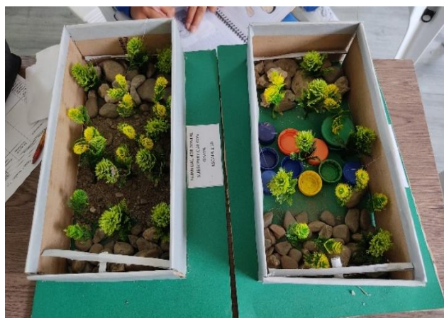
Figura 45: Maquetas humedal subsuperficial de flujo horizontal en grava y plástico, escala 1:10. Fuente: Autor.
