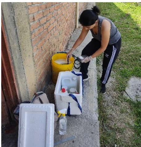
Figura 7: Muestra y medición de pH in situ. Fuente: Autor.
