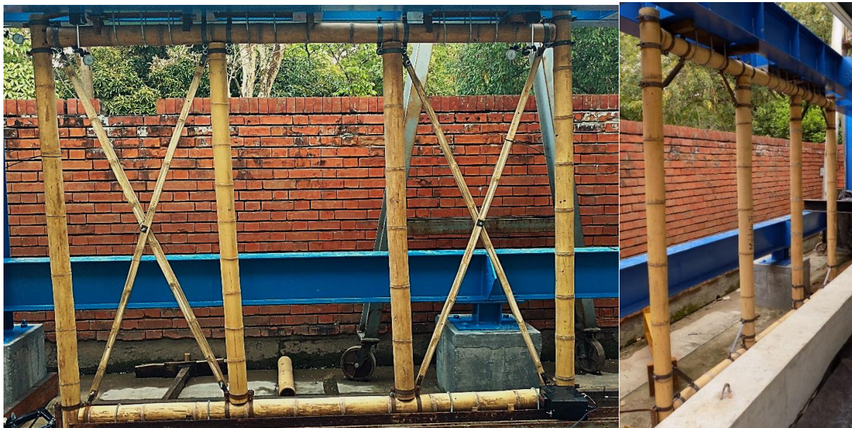
Figura 3. Prototipo de módulo de pared con diagonales de latas de guadua (izquierda) y prototipo de módulo con uniones de momento (derecha)
