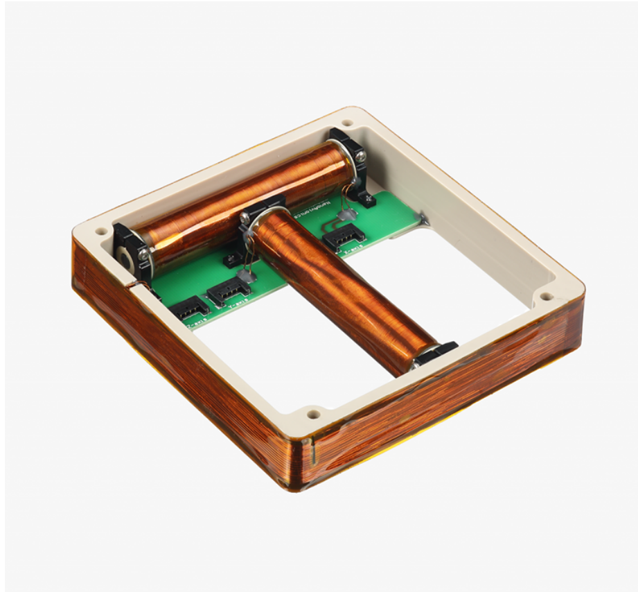
Figura A-3.: Magnetorquer de un nanosatélite. Tomado de https://bit.ly/3wZCY28 .
