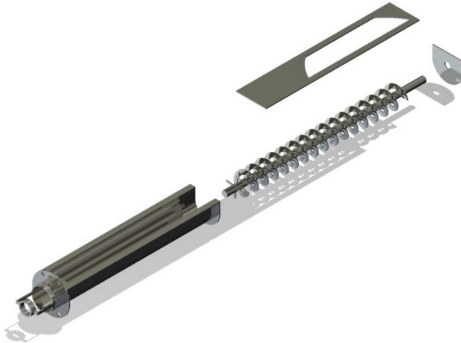
Figura 11. Despiece del tornillo alimentador
