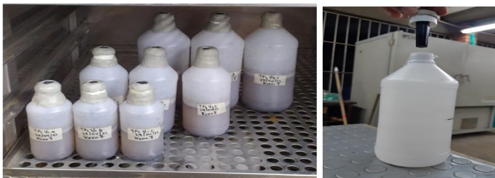
Figura 3. Configuración de reactores (izq); Capuchón para almacenamiento de perlas de NaOH (der)
