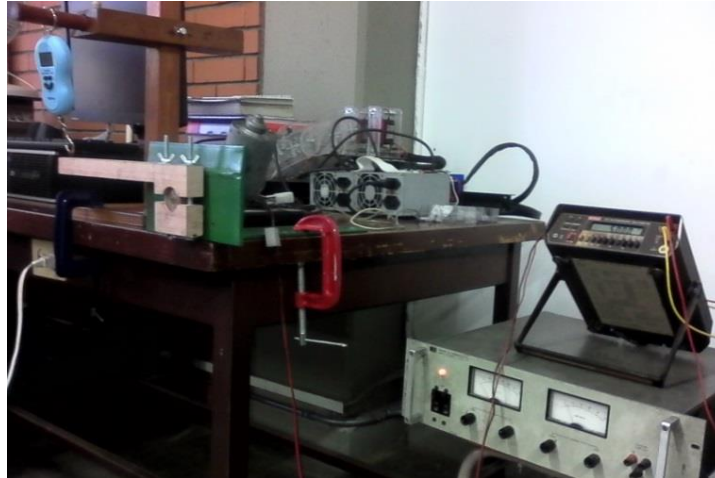
Figura 27. Montaje del dinamómetro
