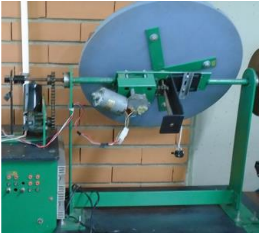
Figura 65. Transmisión por cadena en los elementos articulares
