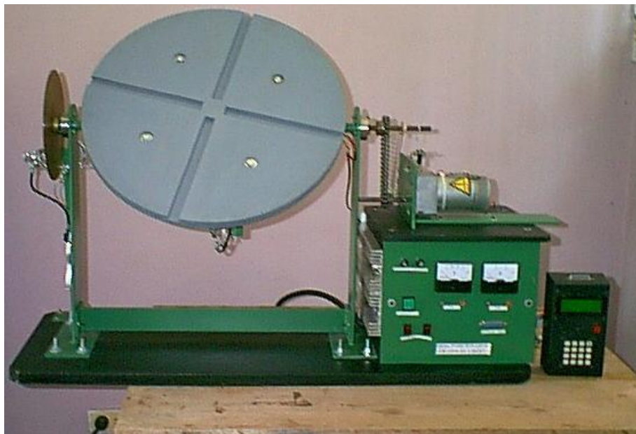
Figura 1. Mesa giratoria de dos grados de libertad.
