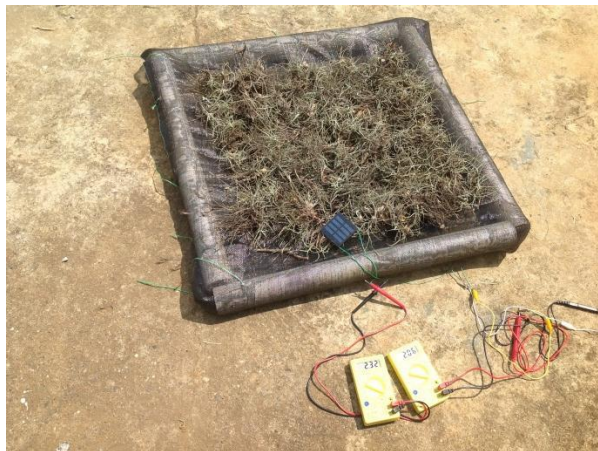
Fotografía 25. Modulo para realizar las mediciones experimentales con plantas de los alrededores y con los radiómetros registrando valores de radiación solar simultáneamente. Fotografía tomada el 29 de noviembre de 2012 en la granja experimental de la Universidad del Valle.
