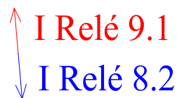
Figura 42. Diagrama vectorial de contribución a la corriente de falla DG 9 (segunda vecindad del Relé 8.2)
