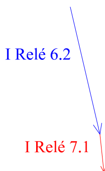
Figura 48. Diagrama vectorial de corriente de falla 3 (primera adyacencia del Relé 6.2, segunda adyacencia del Relé 7.1)
