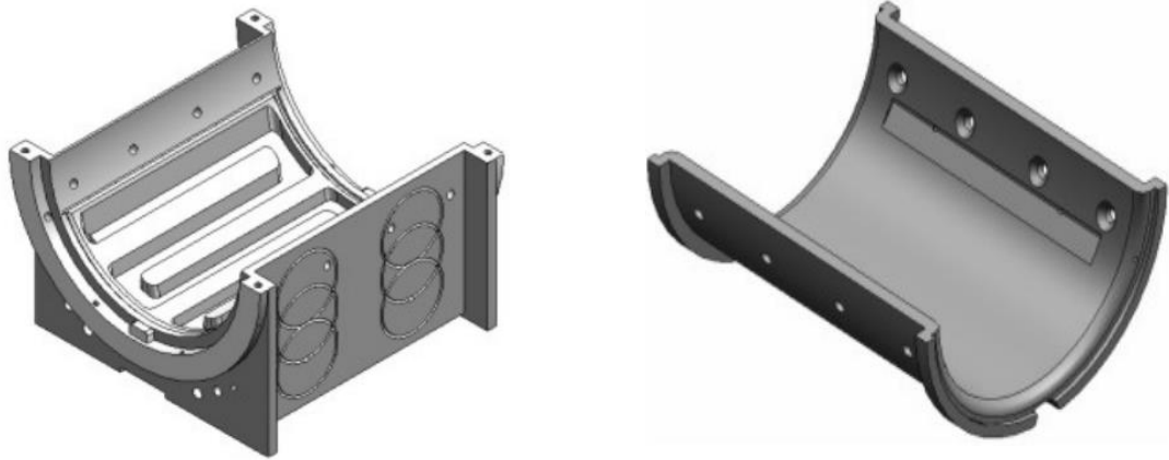
Figura 12. Conductos de refrigeración y lubricación (a) Caja, (b) Teja superior. Fuente: (Coronado et al., 2005)
