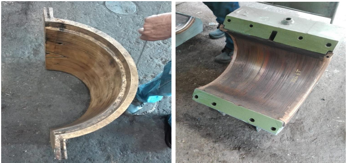
Figura 8. Teja de bronce de un molino de un ingenio azucarero de Colombia. (Fuente: Cenicaña)
