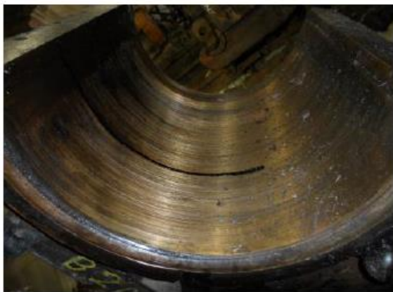
Figura 2. Chumaceras de bronce: (a) En buen estado y con poco desgaste, (b) Con desgaste adhesivo y abrasivo, (c) Con desgaste abrasivo severo. Fuente: (Viascán, 2017)
