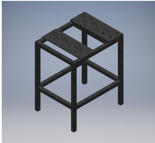
Figura 49. Geometría CAD de la estructura base.
