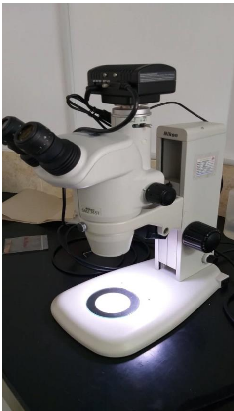
Figura 28. Estereoscopio para medir ancho de las huellas de desgaste.
