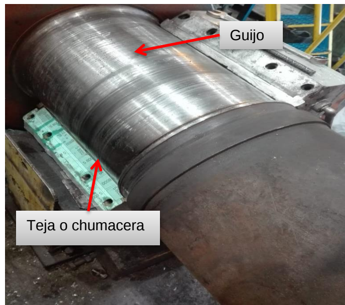
Figura 7. Guijo de un molino de caña de un ingenio del Valle del Cauca. (Fuente: Cenicaña)
