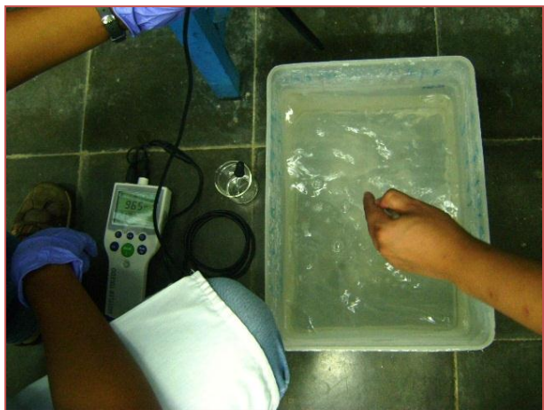
Fig.16. Fotografía control de PH
