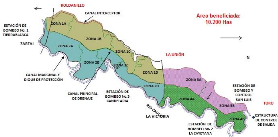
Ilustración 6. Red de canales de Distrito ASORUT.
