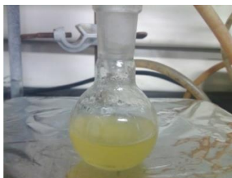
Figura 8.51. Test de mercurio en DMF a las 6 horas de reacción (Catálisis homogénea).
