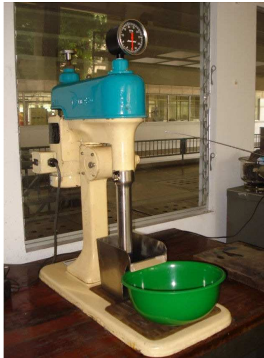
Figura 6. Celda de flotación
