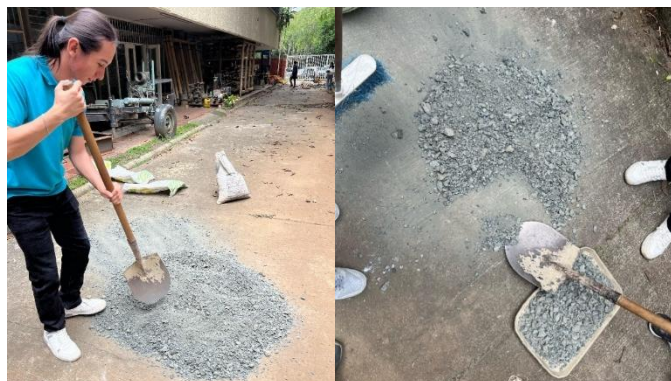
Ilustración 3. Mezcla y cuarteo para toma de muestra de material granular.
