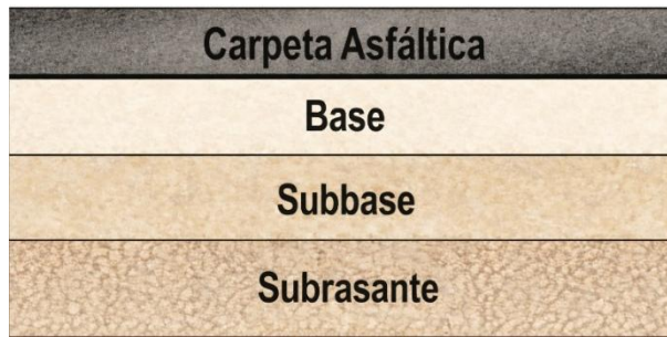
Ilustración 1. Estructura típica de carretera.
