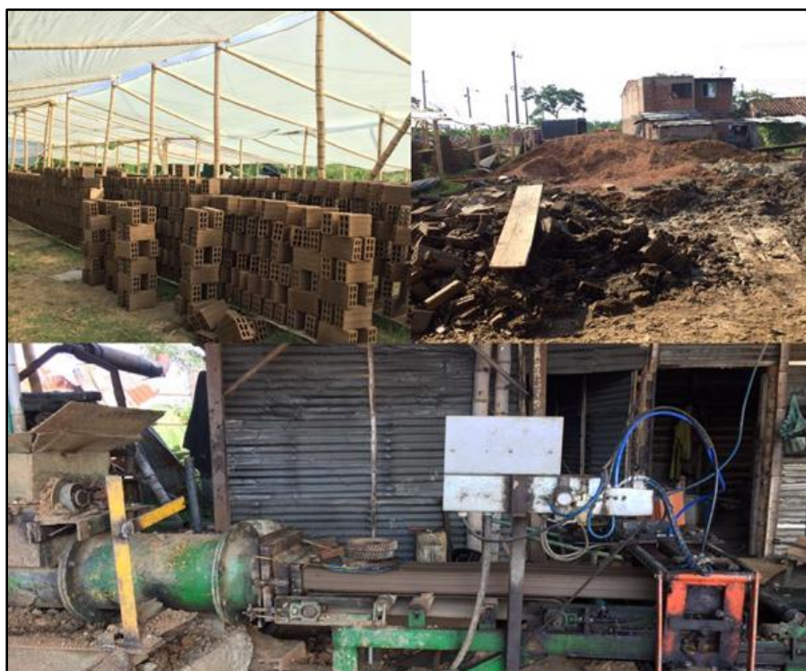
Imagen 1. Modelo semi-industrial de explotación de arcilla y producción de ladrillos.
