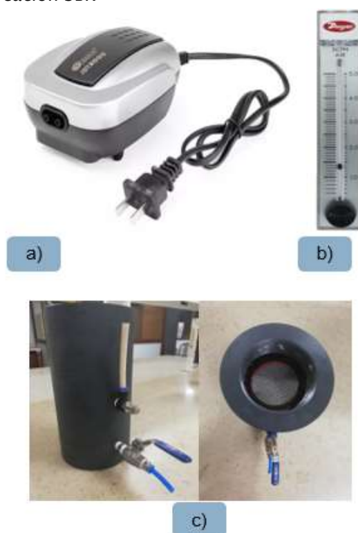
Figura 4–7 Equipos de aireación SBR
