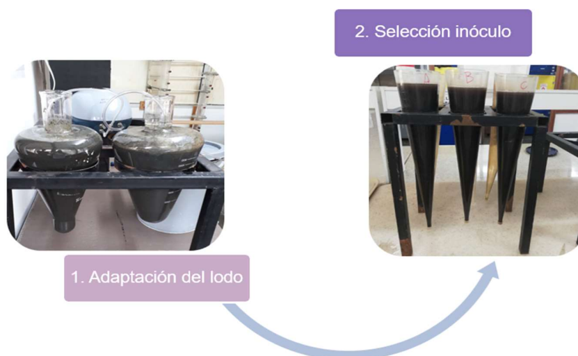
Figura 3-2 Adaptación del lodo y selección del inóculo
