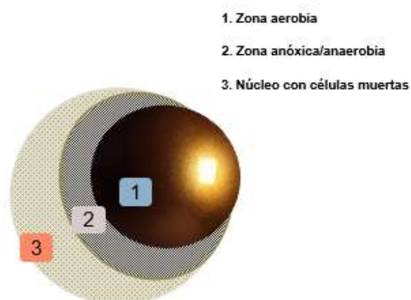
Figura 5-1 Estructura en capas de un gránulo aerobio
