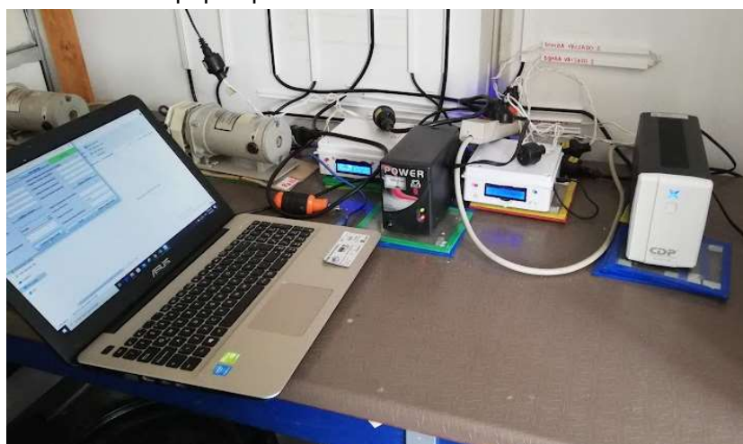
Figura 4–9 Ensamble de los equipos para la automatización del SBR
