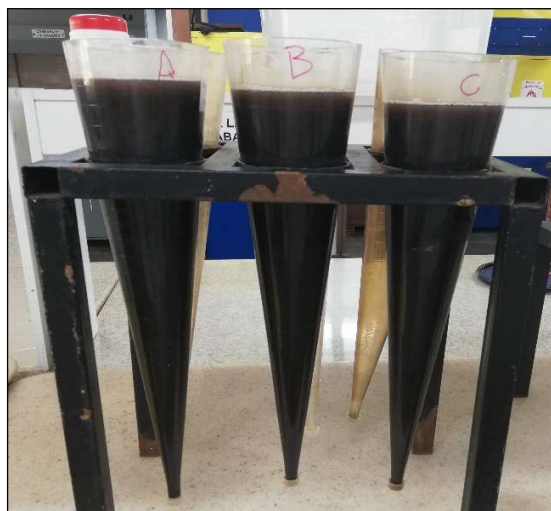
Figura 5-6 Pre tratamiento de lodos en conos Imhoff de 1L
